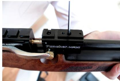
СНИМИТЕ ДВА ВИНТЫ
