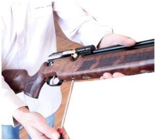
ЛОЖА ВАШЕЙ ВИНТОВКИ СБАЛАНСИРОВАНА ПО ЦЕНТРУ ТЯЖЕСТИ. ЛОЖА ЗАФИКСИРОВАНА ОДНИМ ВИНТОМ С ВНУТРЕННИМ ШЕСТИГРАННИКОМ. ВЫ МОЖЕТЕ ЕЕ ЛЕГКО СНЯТЬ С ПОМОЩЬЮ КЛЮЧА-ШЕСТИГРАННИКА.
