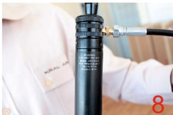
ЗАПРАВОЧНЫЙ ВЫХОД РАСПОЛОЖЕН В ВЕРХНЕЙ ЧАСТИ БАЛЛОНА (см.рис. 8). ПОДСОЕДИНИТЕ ШЛАНГ НАСОСА К ПЕРЕХОДНИКУ ДЛЯ ЗАРЯДКИ БАЛЛОНА. ПЕРЕХОДНИК ИДЕТ В КОМПЛЕКТЕ С ВАШЕЙ ВИНТОВКОЙ. ЕСЛИ ВЫ СЛЫШИТЕ ТРАВЛЕНИЕ ВОЗДУХА ВО ВРЕМЯ ПЕРВОЙ НАКАЧКИ, ПОДТЯНИТЕ ПЕРЕХОДНИК. (ЕСЛИ УТЕЧКА БУДЕТ ПРОДОЛЖАТЬСЯ, УПЛОТНИТЕЛЬНОЕ КОЛЬЦО МОЖЕТ БЫТЬ ДЕФОРМИРОВАНО, ЗАМЕНИТЕ ЕГО)
