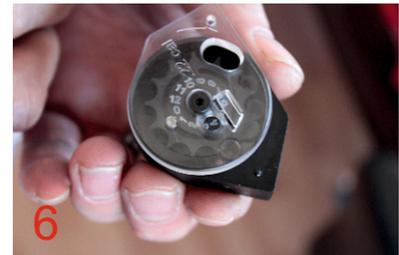
КОГДА ОКНО ЗАРЯДКИ В КРЫШКЕ ДОСТИГНЕТ ПОСЛЕДНЕЙ ПОЗИЦИИ, НЕ ПРОИЗВОДИТЕ ТОЛКАЮЩЕ УСИЛИЕ НА ПРУЖИНУ. КРУТИТЕ КРЫШКУ В ОБРАТНОМ НАПРАВЛЕНИИ И ВСТАВЛЯЙТЕ ПУЛИ. **ВНИМАНИЕ:** НЕ ПРИМЕНЯЙТЕ УСИЛИЕ, ЭТО МОЖЕТ ПРИВЕСТИ К ПОЛОМКЕ КОНСТРУКЦИИ.
